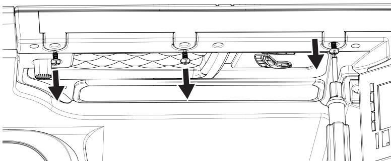
①ドア上部の内側に取付けられている固定ネジ3本を、プラスドライバーで緩めてはずしてください。
