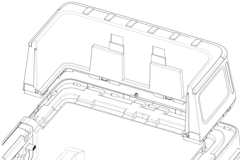
①リアバックパネル底面のツメを、車体の取付け穴に合せて、上から軽くたたきながらはめ込んでください。
