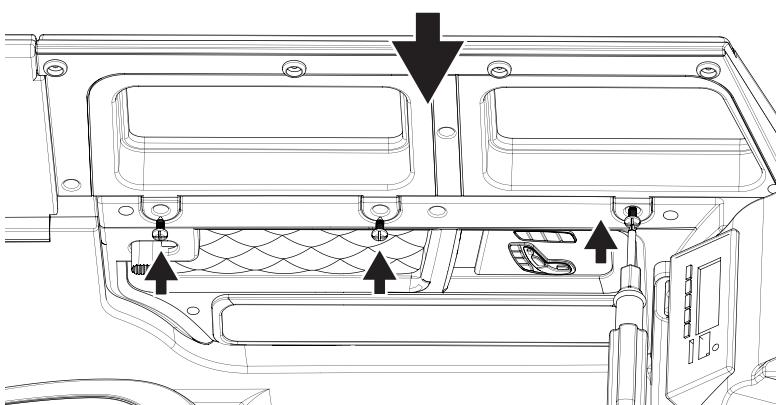
①ドア上部パネルをドアのはめ込み部分にはめ込みます。
