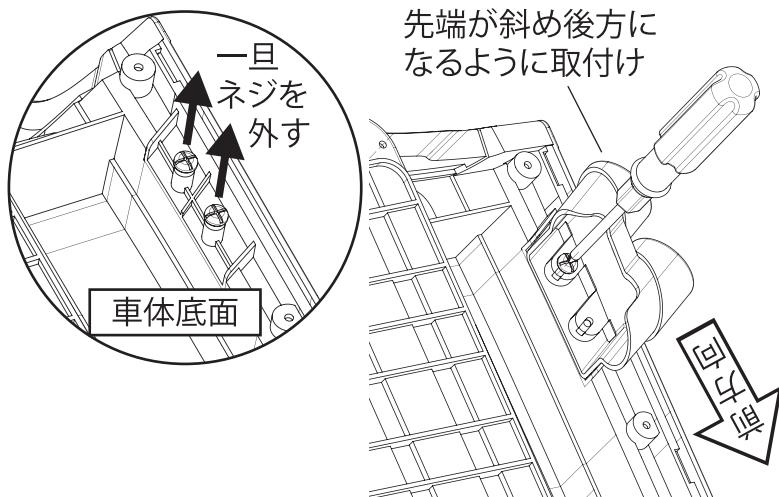
①車体底面の両端にサイドマフラー取付け穴があります。その穴に仮止めされているネジを一旦外します。(片側2本、左右計4本)
