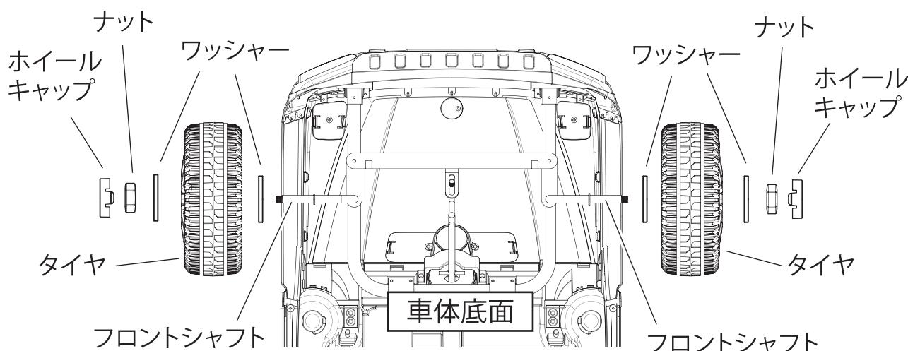
①フロントシャフトの末端に仮止めされている、ナットとワッシャー1枚を外してください。もう1枚のワッシャーは、左右フロントシャフトにはめたままにしておいてください。
