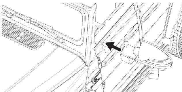
①左右を確認し、サイドミラーを車体ドア部の取付け穴に差込みます。
