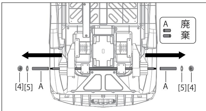
①. レンチ⑩を使ってリアシャフト両端のナット[4]とワッシャー[5]とモーター固定部品Aを取り外してください。
