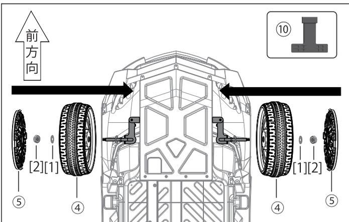
④. 次にレンチ⑩を使ってナットを締めて取付けます。
