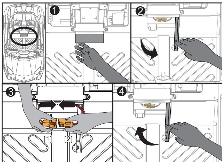
①. 車体本体の座席取付け部横の配線カプラ収納部の蓋を矢印の方向へ開いてください。
