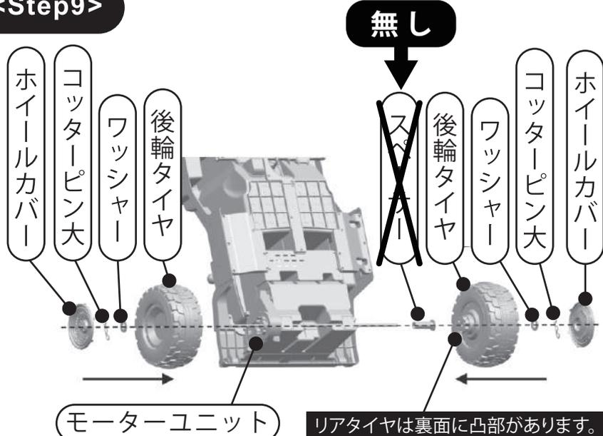
① 左図を参考に、リアシャフトに各パーツを取付けてください。
