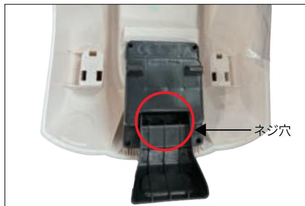
車体を裏返し、後輪の間に位置するくぼみに、転倒防止ストッパーを取り付けます。
