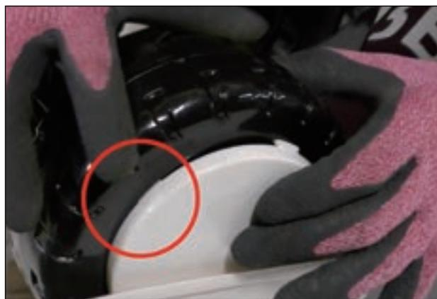
シャフト先端の穴に、コッターピンを差し込み、タイヤを固定します。
