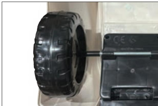
先程通したものを、タイヤハウスに設置し、取り付け穴に通します。
