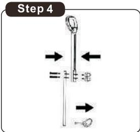
手押し用ハンドルとコネクチューブを2本のボルトとナットで固定します。この時コネクチューブに付いているピンを取り外してください。
