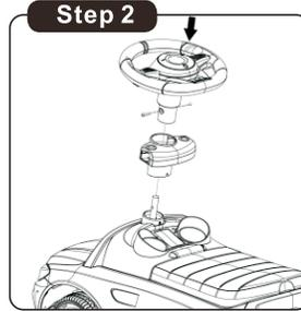
セーフティーバー固定パーツとハンドルにJ型シャフトを差し込み、シャフトとハンドルのボルト取り付け穴の位置を合わせて、ボルトとナットで固定します。
