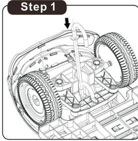
図の通りに車体底面からJ型シャフトを挿入します。
