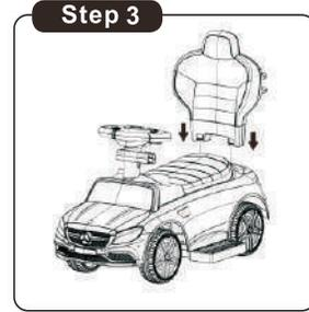
図の通りに車体取り付け位置に合わせてバックレストを差し込みます。車体前部を押さえながら、バックレストを強く差し込み、抜けないようにして下さい。
