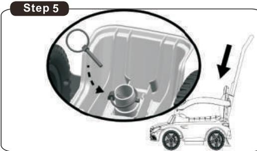
手押し用ハンドルをバックレストの穴に差し込み、車体を裏返し、Step4 で取り外したピンで固定してください。
