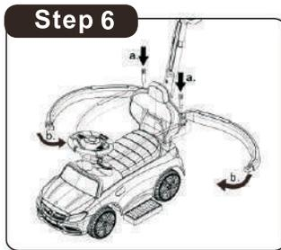
セーフティーバーをバックレストにピボットピンで組み付けます。そしてセーフティーバー先端をセーフティーバー固定パーツの穴に入れます。
