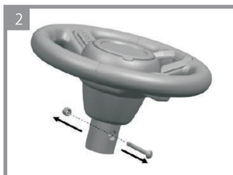
ハンドルの根元についているボルトとナットを、プラスドライバーを使用して一旦外します。
