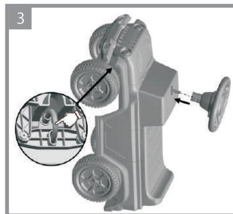
車体の底面側からJ型シャフトを押さえ、車体上部から出たシャフト先端の穴とハンドルの穴を合わせてください。
