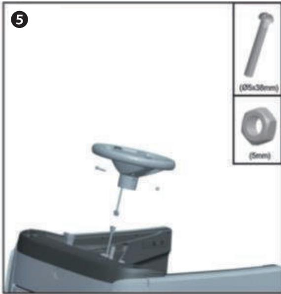
・コネクタをつなぎ、ハンドルを旋回軸に入れて、ボルトとナットで固定してください。※配線を切らないよう注意してください。ハンドル軸に絡ませたりすると、お子様がハンドルを切った際に断線する場合があります。
