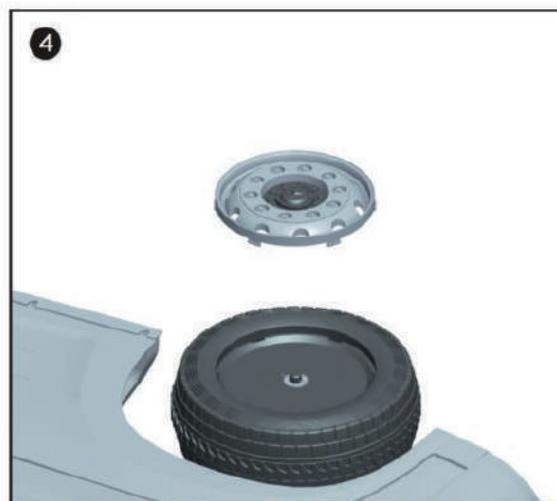
※車輪カバーはツメを車輪の溝に差し込んで固定してください。
