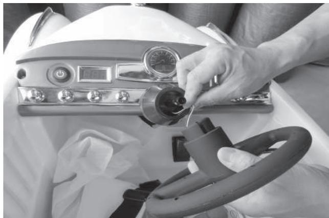
⑤ ハンドル取付け部にハンドルを差し込んだ後、②で外したネジとナットを取り付けてください。
