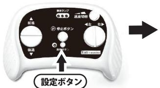
②「設定ボタン」の横の赤ランプが点滅している間に車体の電源を入れる。
