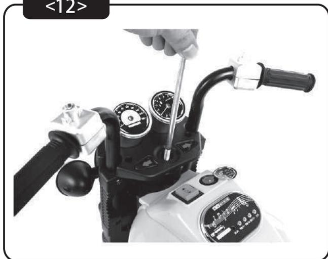
①先ほど抜いたハンドルシャフトを車体の取付け穴に合わせて差込みます。
