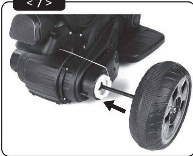
①. 後輪シャフトに後輪タイヤを差込み、車体の後輪シャフト穴に差し込んでください。
