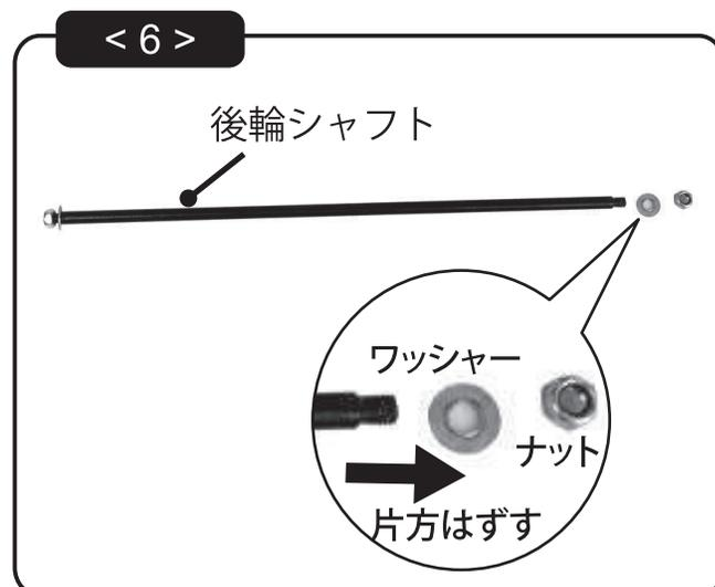
①後輪シャフトの先端に仮止めされているナットとワッシャーを、付属のレンチを使用して片方だけ外してください。
