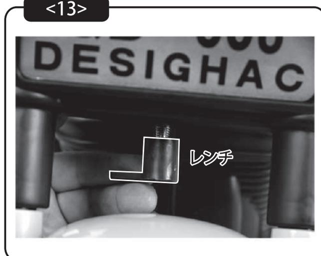
①ナットをハンドルシャフトの末端に取り付け、付属のレンチで締めて固定します。
