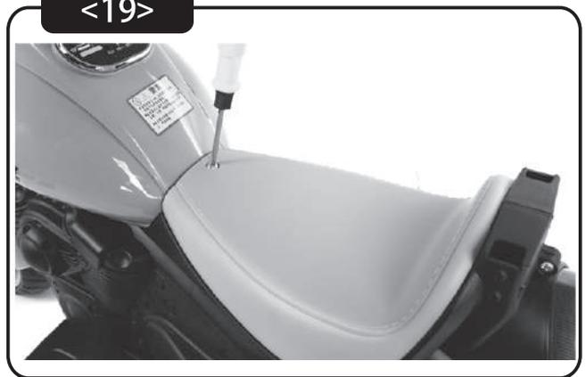
①シートを車体の取付位置に合わせ、先ほど外したネジを使用して、プラスドライバーで締めて固定します。
