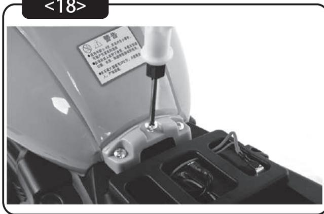
①車体に仮止めされている、シート取付け用のネジを外します。
