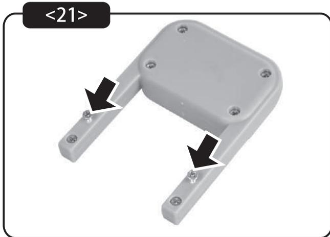
①バックレストの背面に仮止めされている2本のネジを外してください。
