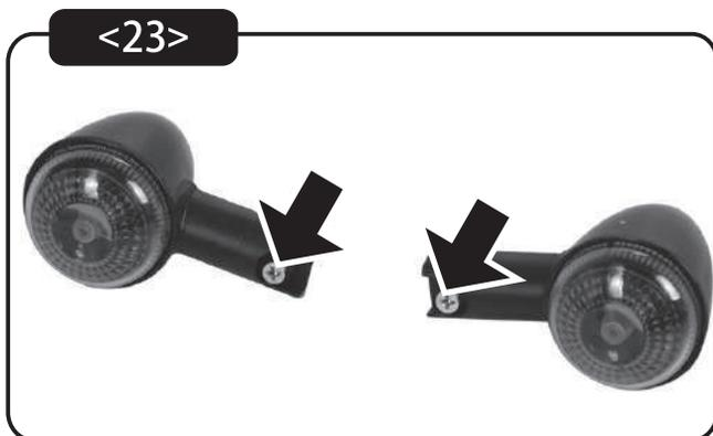
①ウィンカーに仮止めされているネジを外してください。
