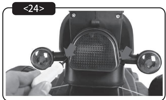
①ウィンカーを車体後部の取付け穴に差込み、先ほど外したネジで固定してください。
