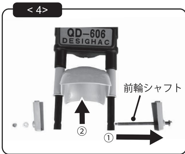
①ハンドル下部の前輪シャフトのナットを付属のレンチで緩め、前輪シャフトを外します。
