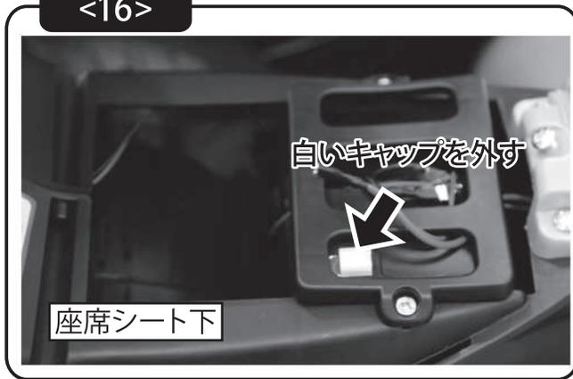
①座席シート取付け部にあるバッテリー端子の白い保護キャップを外します。
