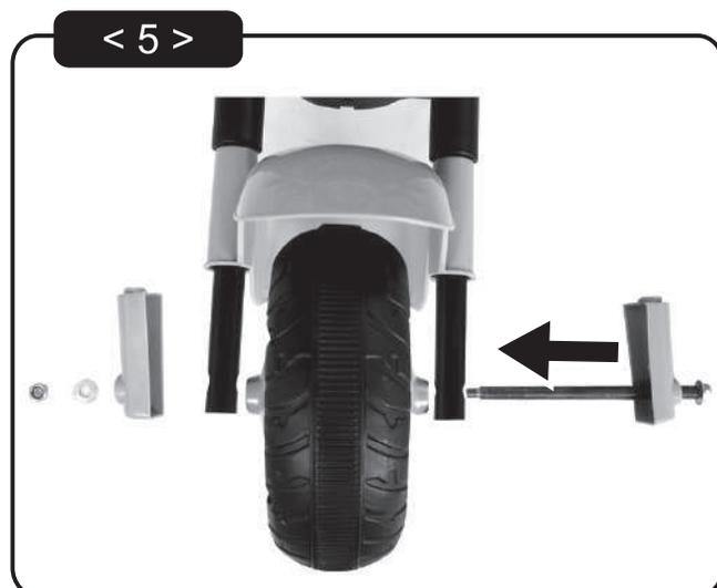
①. 前輪タイヤをフロントフォークに挟むようにして、先ほど外した前輪シャフトを通します。
