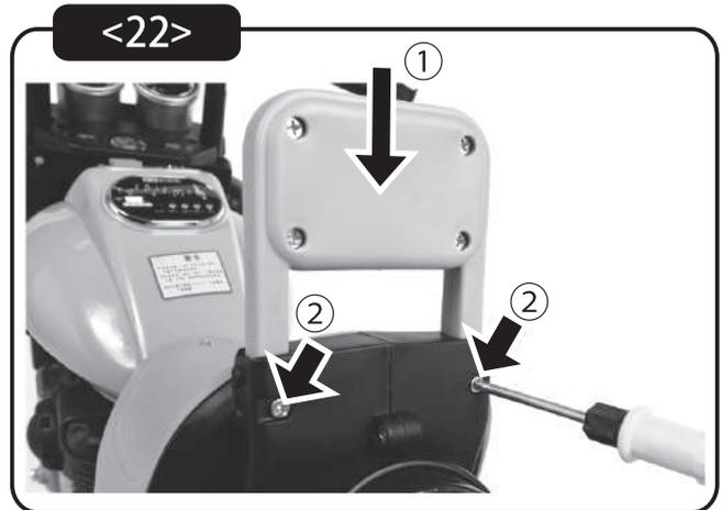
①バックレストを車体後部の取付け穴に差込んでください。
