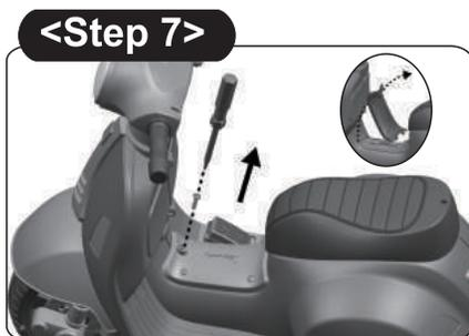
7. 車体の中央部にバッテリーカバーがありますので、プラスドライバーでネジを緩めてカバーを外してください。
