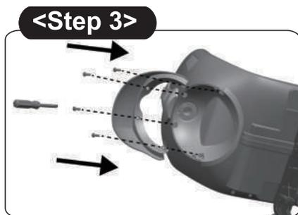
3. 車体前面に、フロントフェンダーを取り付け位置に合わせてください。次に付属のネジ4本を使用してプラスドライバーで締め固定してください。
