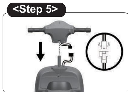
5. ハンドルと車体側から出ている配線端子を接続してください。次に配線端子が邪魔にならないように、端子を車体の配線穴に押し込んでください。
