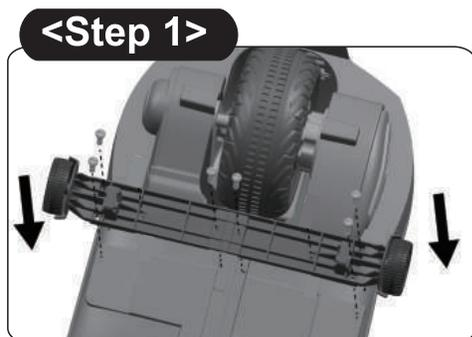
1. 車体底面に、補助タイヤを取付位置に合わせてください。前後・裏表がありますのでご注意ください。次に付属のネジ5本を使用してプラスドライバーで締めて固定してください。
