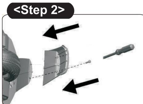
2. 車体後部に、リヤフェンダーを取付位置に合わせてください。次に付属のネジ1本を使用してプラスドライバーで締めて固定してください。
