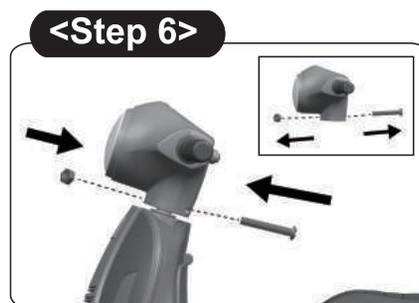
6. ハンドルの下側についているネジとナットをプラスドライバーを使用して、一旦外します。ハンドルを先ほどの前輪タイヤのシャフトに差込み、ハンドルのネジ穴と前輪タイヤのシャフトにある穴とを合わせて、再度ネジとナットで固定してください。
