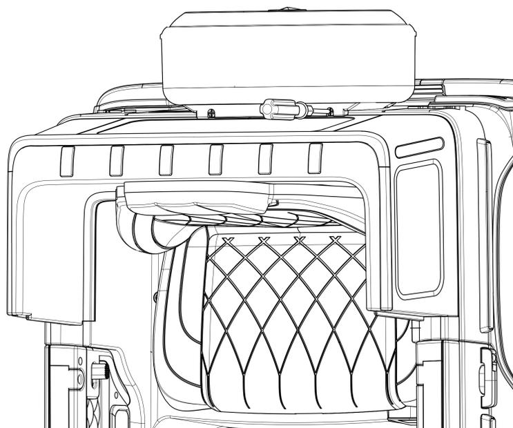
①車体の背面に仮止めされている、背面タイヤ取付け用ネジ**2本**をプラスドライバーで緩めてはずしてください。
