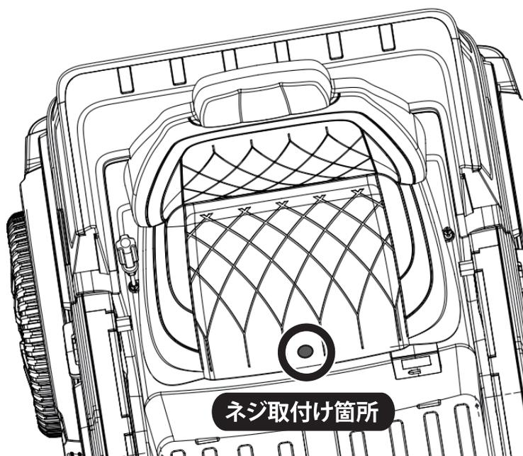
①車体のシート取付け部に仮止めされている取付け用ネジ**1本(座面前中央)**を、プラスドライバーで緩めて外します。
