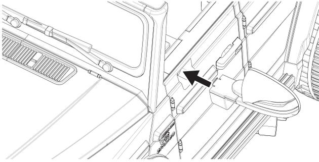
①左右を確認し、サイドミラーを車体ドア部の取付け穴に差込みます。
