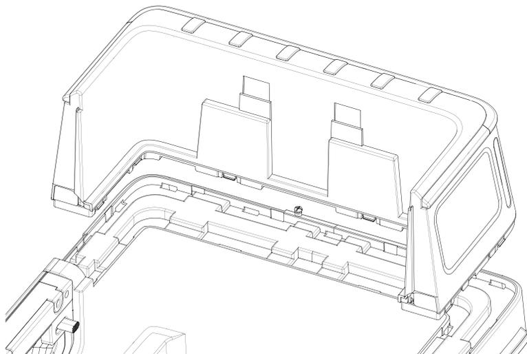
①リアバックパネル底面のツメを、車体の取付け穴に合わせて、上から軽くたたきながらはめ込んでください。
