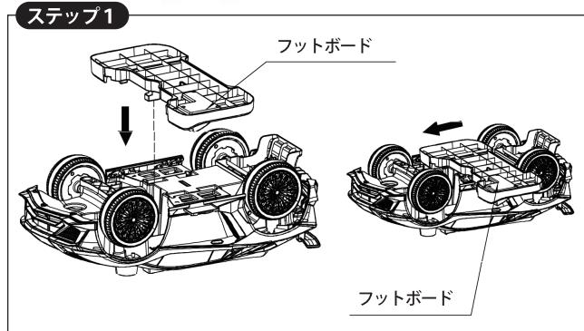
車体を裏返し、フットボードをはめ込みます。フットボードを図のように矢印の方向（車体前方向）にスライドさせ、しっかりとはめ込んでください。
