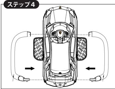
左右のセーフティーバーを、ハンドル下のセーフティーバー固定パーティと、バックレスト側面の穴にそれぞれはめ込みます。
