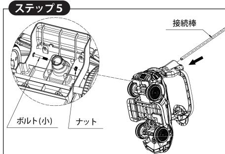
接続棒をバックレストにはめて、車体裏側から取付穴を合わせてボルト（小）とナットを使用してプラスドライバーで締めて固定します。
