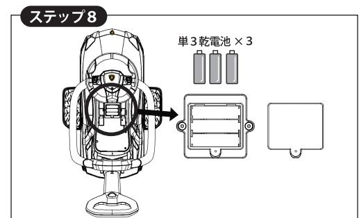
座席シートを開き、内部にある電池カバーをプラスドライバーで緩めて外してください。電極を間違えないようにして、単3乾電池を3本入れます。再度ネジを使用して電池カバーを取り付けてください。
