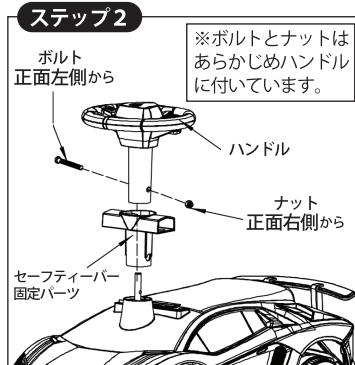
車体を元に戻します。ハンドルに付属しているボルトとナットを外し、セーフティーバー固定パーティ→ハンドルの順に取り付けます。それぞれの取付穴を合わせて、再度ボルトとナットで固定し直してください。
