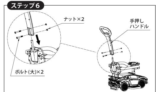
手押しハンドルを接続棒に挿し込み、ボルト（大）とナットを使用して、プラスドライバーで2ヶ所固定してください。
