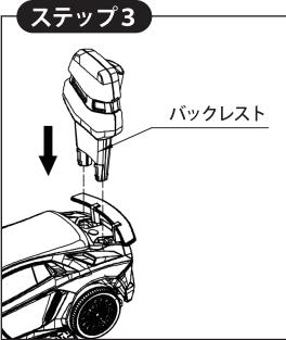
バックレストの前後を確認し、車体上部の後方にある取付穴に上から強く押して挿し込んでください。
