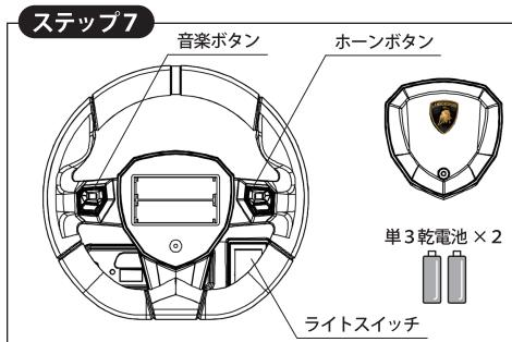
ハンドル中央部の電池カバーのネジをプラスドライバーで緩めて、フタを外してください。電極を間違えないようにして、単3乾電池を2本入れます。再度ネジを使用して電池カバーをハンドルに取り付けてください。
