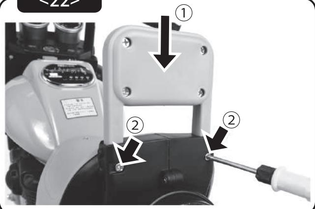
①バックレストを車体後部の取付け穴に差込んでください。
