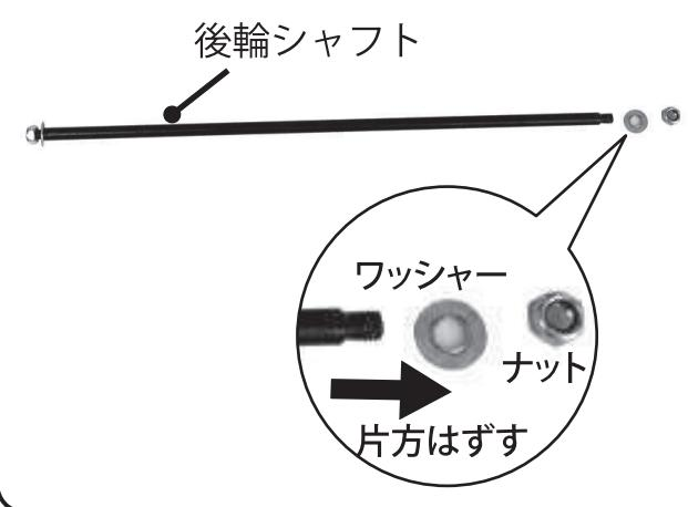
①後輪シャフトの先端に仮止めされているナットとワッシャーを、付属のレンチを使用して片方だけ外してください。
