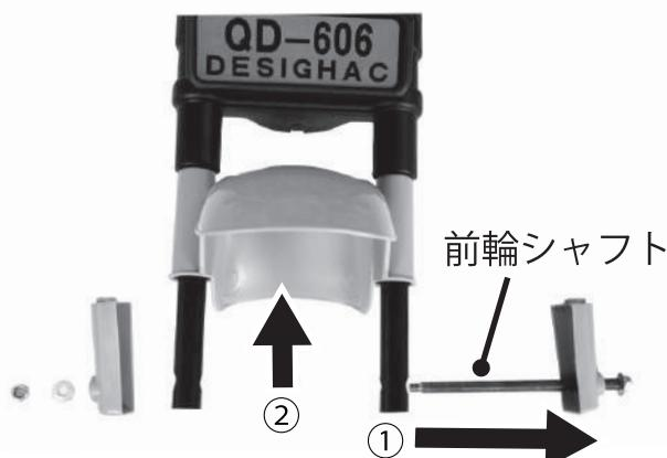
①ハンドル下部の前輪シャフトのナットを付属のレンチで緩め、前輪シャフトを外します。
