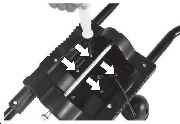
①. ハンドルの背面から、ライトの取付穴に先ほど外したネジを合せ、プラスドライバーで締めて固定します。
