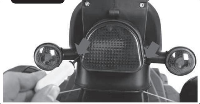
①ウィンカーを車体後部の取付け穴に差込み、先ほど外したネジで固定してください。
