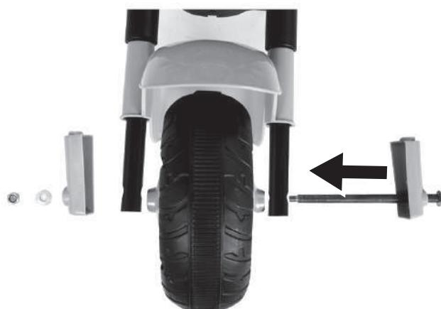
①. 前輪タイヤをフロントフォークに挟むようにして、先ほど外した前輪シャフトを通します。
