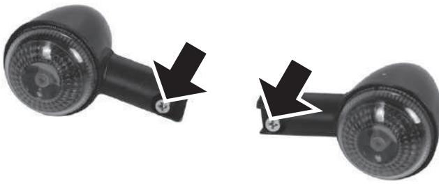
①ウィンカーに仮止めされているネジを外してください。
