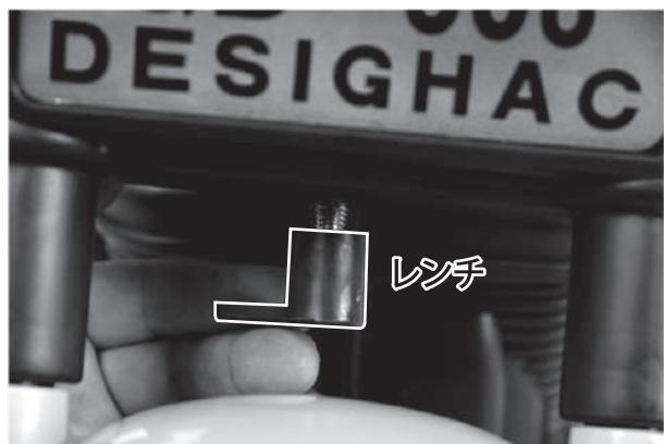
①先ほど抜いたハンドルシャフトを車体の取付け穴に合せて差込みます。
