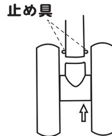
『後輪』を『メインフレーム』の末端にある金属の止め具（2つ）を指で押さえながら、挿し込んでください。
