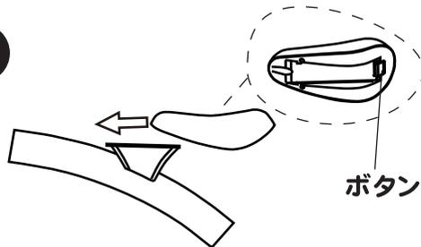
『シート』の裏側にあるボタンを押さえながら、『メインフレーム』のシート取付け部にスライドさせながら取付けてください。
