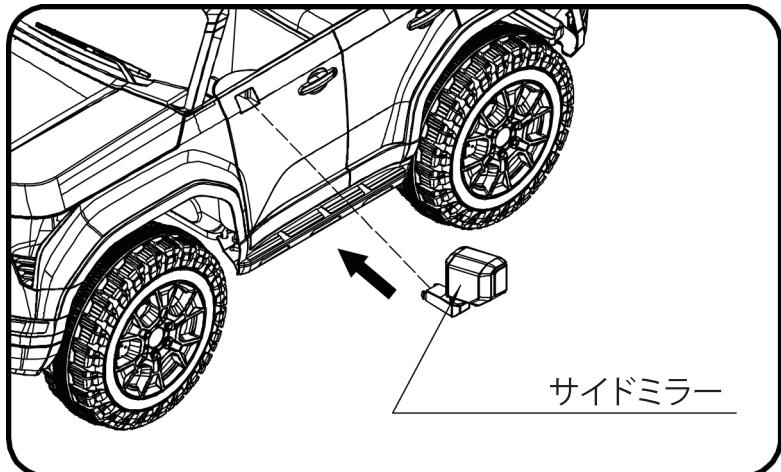
① 左右を確認し、サイドミラーを車体ドアの取付け穴に挿し込みます。
