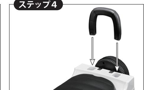
バックレストの前後を確認して、車体上部の後方にある取付け穴に、上から強く押して挿し込んでください。
