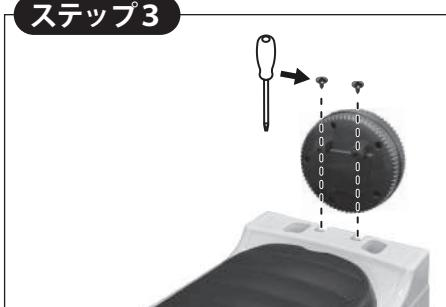
スペアタイヤを車体の背面取り付け部に合せ、2本のネジを取り付け、プラスドライバーで締めて固定してください。
