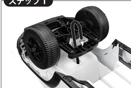
底面の前方向にあるシャフト取付け穴に、J型シャフトを挿し込みます。この時、J型シャフトの曲がっている先端部分をタイヤ可動ステーの中央穴に挿し込みます。
