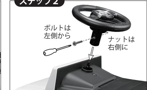
車体を横にし、車体底面からJ型シャフトを押された状態で、上面に出た先端にハンドルを挿し込みます。それぞれの取付け穴を合せて、車体左側からボルトを通して、右側から出たボルトにナットを取り付け、プラスドライバーで締めて固定してください。
